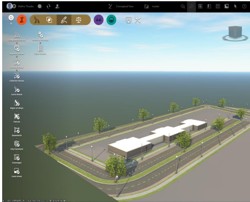
Software: Autodesk InfraWorks Darstellung: Importiertes Revit Modell und im ersten Schritt, testweise erstellte Straße
